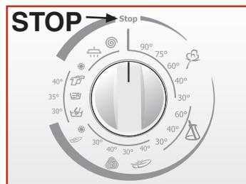
ciclo de lavado se desea cambiar el programa o añadir más ropa, colocar el mando del programador en “STOP” luego, colocar el mando en el programa deseado y accionar el pulsador “START”.
