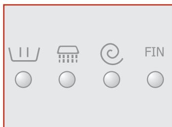
L'illustration latérale indique les 4 fonctions principales d'un cycle de lavage **PRÉLAVAGE - LAVAGE; RINÇAGE; ESSORAGE; FIN**.
