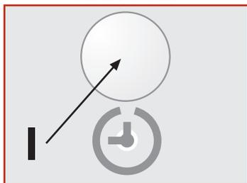
A máquina está equipada com um retardador de arranque que permite adiar o arranque do programa de lavagem até um máximo de 8 horas. As horas podem ser seleccionadas do modo seguinte: A cada pressão do botão (I) corresponde um adiamento de arranque do programa de lavagem de 1, 2, 4, 8, horas, respectivamente. Carregando no botão **START** (L), o led seleccionado pisca ou o botão (I) acende (consoante o modelo de que se dispõe) para indicar que a função
