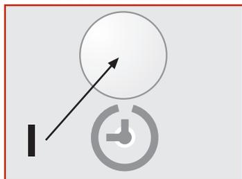
La macchina è dotata di un ritardatore di partenza che permette di ritardare il lavaggio fino ad un massimo di 8 ore. Le ore possono essere selezionate come segue: per ogni pressione del pulsante (I) il lavaggio verrà ritardato di 1, 2, 4, 8 ore.
