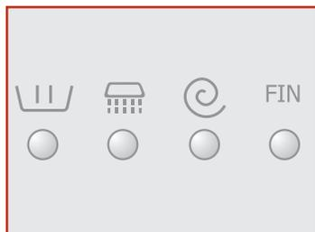
En la figura de al lado se indican las 4 funciones principales de un ciclo de lavado: **PRELAVADO-LAVADO**, **ACLARADO**, **CENTRIFUGADO** y **FIN**. Cada una de estas funciones se indica durante el ciclo de lavado mediante un led luminoso, de manera que siempre se puede saber a qué punto se encuentra el lavado.
