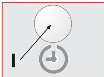
La máquina está dotada de un retrasador de partida que permite retrasar el lavado hasta un máximo de 8 horas. Las horas pueden seleccionarse de la siguiente manera: por cada presión del pulsador (I) el lavado se retrasa 1, 2, 4, 8, horas. Al presionar la tecla START (L), el led seleccionado parpadea o bien el pulsador (I) (según el modelo) se enciende, para indicar que la función ha sido habilitada; desde ese momento la máquina después de haber esperado el número de horas
